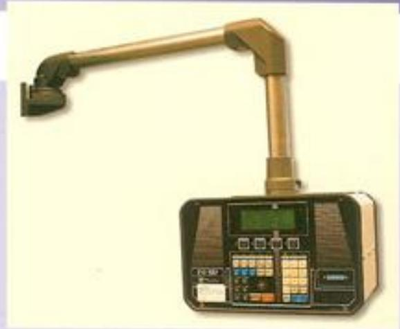
*Montaje del Control numérico colgado a la Prensa Plegadora*
