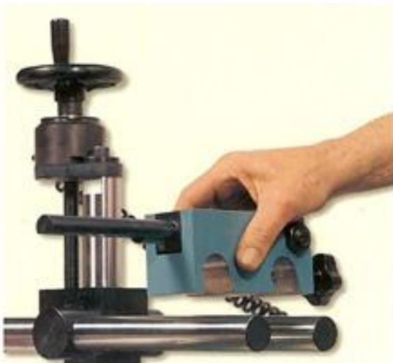
*Detalle del tope, insertable en cualquier posición*
