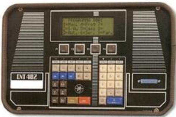
Por medio del visualizador alfanumérico y del teclado del panel de control, permite insertar, modificar y memorizar los programas de trabajo, constituidos por líneas de programación, con las cotas de posición de los ejes.
